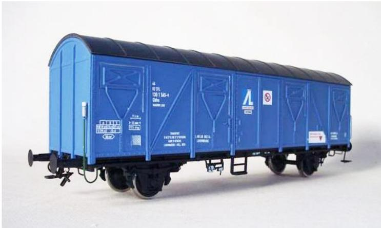
Ins Gehäuse kann etwa 200gr Ballast geklebt, oder ein Tischlerplatte von 16 mm Dicke, die genau auf den Wagenboden passt.
